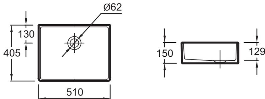
Спецификация продукта: Раковина 51 x 40,5 см. ESA01. Коллекция: DELTA. РАЗМЕРЫ (СМ): 51 x 40,50 см. ВЕС: 13 кг. МАТЕРИАЛ: Санфарфор. ТИП УСТАНОВКИ: Накладные. ОТВЕРСТИЯ ДЛЯ СВЕРЛЕНИЯ: Без отверстия для смесителя. УСТАНОВКА: 0. ГЛАДКАЯ / НЕГЛАДКАЯ НИЖНЯЯ ПОВЕРХНОСТЬ: 0. ОТВЕРСТИЕ ПЕРЕЛИВА: Без отверстия перелива. КОЛИЧЕСТВО РАКОВИН В СТОЛЕШНИЦЕ: 0. ПРОДУКТ В КОМПЛЕКТЕ: 0. РЕКОМЕНДОВАННЫЙ СИФОН: 0. РЕКОМЕНДОВАННЫЙ СМЕСИТЕЛЬ: 0.
